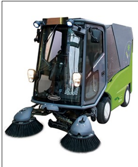
Abbildung 4: elektrisch betriebene Straßenkehrmaschine
